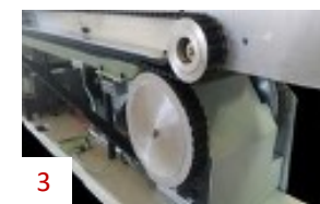
3 Sistema de motor de transmisión directa para eliminar el mantenimiento de la transmisión por cadena
